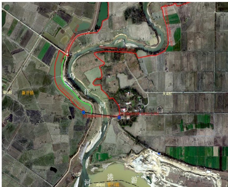
图 4.3-1 乌江河岳阳县干支流交汇处无控制性建筑示例图
